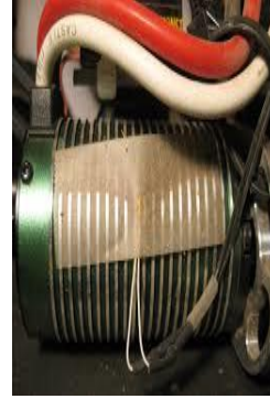
Şekil 2- Dışardan yapıştırılmış, sıcaklık sensörü ve sargıyla entegre dahili sensör.
