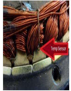
Şekil 2- Dışardan yapıştırılmış, sıcaklık sensörü ve sargıyla entegre dahili sensör.
